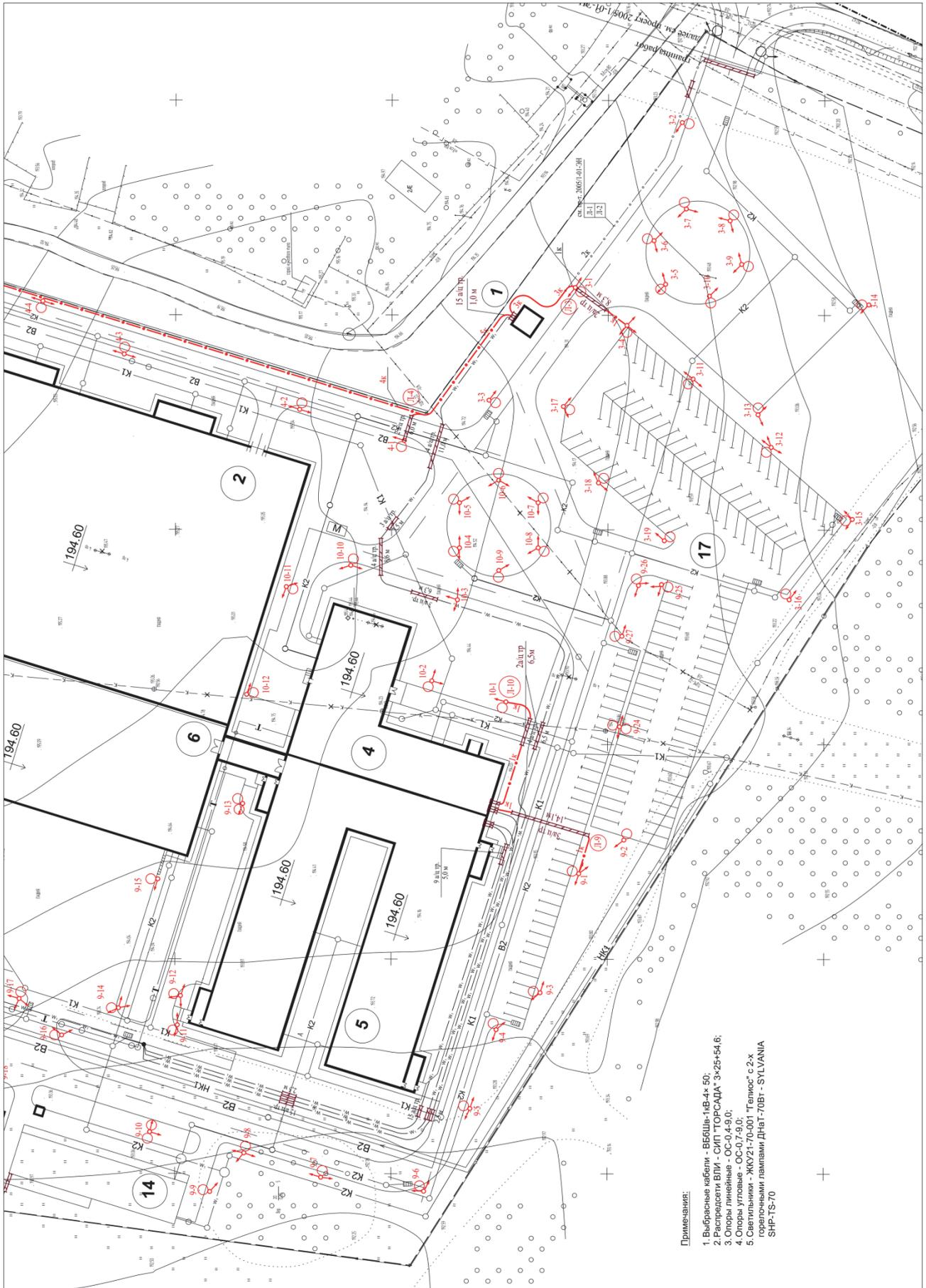
Рис. 5.34 Пример фрагмента плана наружного освещения.
